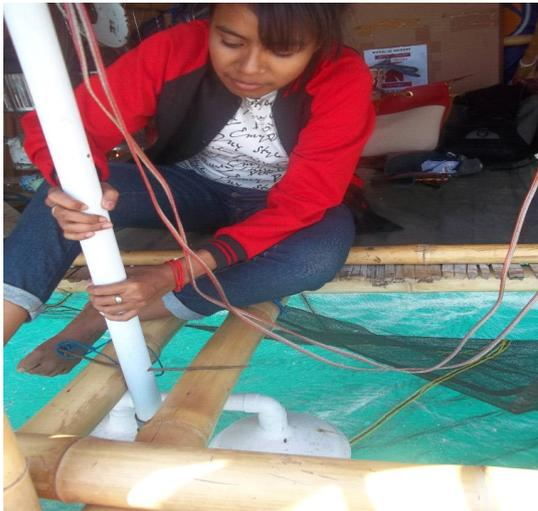
**Gambar 7.** Pengaturan Lampu dengan cara digerakkan naik turun menyesuaikan tinggi air laut
